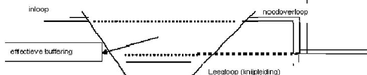
Er moet in de te verwachten bouwvergunning(en) een dwarsprofiel van het bufferbekken bijgebracht worden met het niveau van de inloop, knijpleiding en eventuele overloop. Het volume dat voor buffering instaat is het volume tussen de knijpleiding en de eventuele overloop.
