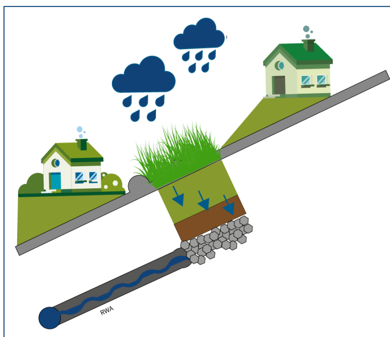
Figuur 4: Groen verkeerseiland om afstroom af te remmen (principetekening)
